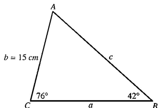
Si observamos, podemos ver que nuestro triángulo tiene dos ángulos y un solo lado, por lo cual podemos aplicar la ley de senos, sin embargo, podemos realizar un análisis sencillo para hallar el otro ángulo desconocido, tomando en cuenta que; la suma de los ángulos interiores de cualquier triángulo debe ser:  $180^\circ$ , la formula se ve así:
