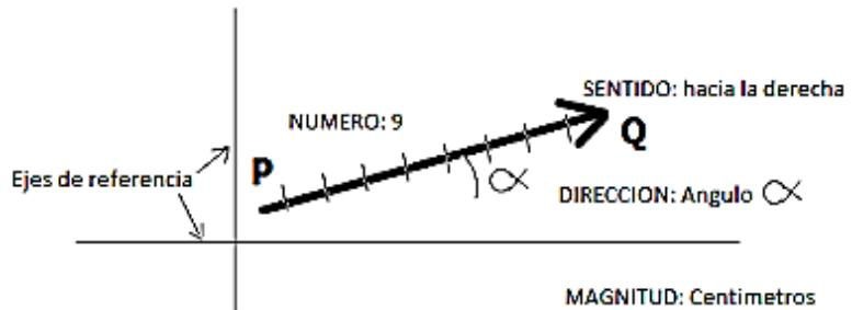
En otras palabras los vectores se representan gráficamente por segmentos acabados en una punta de flecha. Queda determinado su módulo por la longitud del segmento; su dirección por la recta a que pertenece; y su sentido por la punta de la flecha. Al origen del vector se le llama punto de aplicación.
