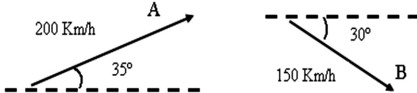
**Solución.** Se coloca el fin del primer vector (A) con el principio del siguiente vector (B).
